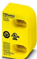
Commutateur de sécurité sans contact jusqu'à Cat. 4, PL e (EN ISO 13849), SIL 3 (CEI 61508), actionneur codé, compatible avec tous les types de détrompage des capteurs, alimentation inductive par le capteur, IP69K
