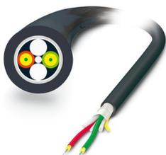
Câble rond GOF ultra-robuste à confectionner (uniquement têtes IP20), pour pose extérieure, avec une protection intégrée contre la vapeur ainsi qu'une couche en tissu de verre résistante aux rongeurs. Eléments individuels en matériau FRNC ultrasouple. Le câble est résistant à l'ozone et aux UV et possède une gaine extérieure très robuste en polyéthylène.
