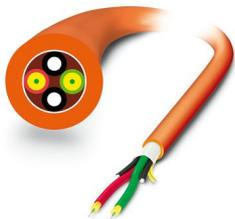
Câble d'installation robuste POF à équiper (seulement têtes IP20) pour le câblage dans des installations et machines fixes, éléments anti-traction en aramide, éléments individuels en matériau FRNC, exempt d'halogène, résistant à l'ozone et aux UV, avec gaine extérieure en polyuréthane (PUR)
