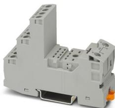
Embase de relais RIF-2, pour relais industriels avec 2 ou 4 contacts inverseurs, raccordement vissé, enfichabilité pour modules d'entrée/antiparasite, montage sur NS 35/7,5
