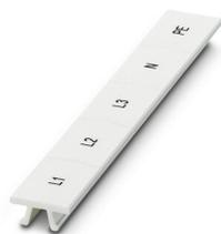
Ruban de repérage ZB, Rubans, blanc, repéré, impression longitudinale: L1, L2, L3, N, PE, type de montage: encliquetage, pour bloc de jonction au pas de : 15,2 mm, surface utile: 10,5 x 15,1 mm, Nombre d'étiquettes: 5
