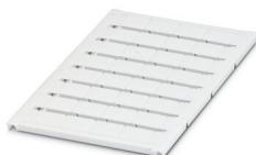
Repères pour blocs de jonction, à commander : sous forme de planche, blanc, impression selon les indications du client, type de montage: encliquetage dans la rainure de repérage élevée, pour bloc de jonction au pas de : 16 mm, surface utile: 15,45 x 10,5 mm, Nombre d'étiquettes: 32
