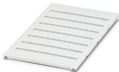
Repères pour blocs de jonction, à commander : sous forme de planche, blanc, impression selon les indications du client, type de montage: encliquetage dans la rainure de repérage élevée, pour bloc de jonction au pas de : 6,2 mm, surface utile: 5,6 x 10,5 mm, Nombre d'étiquettes: 80
