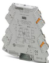
Amplificateur-séparateur configurable NAMUR à technologie de raccordement enfichable, pour détecteurs de proximité et contacts de commutation indépendants du potentiel de terre et couplés avec des résistances. 2 sorties transistor, configurables par DIP switch. Technologie de raccordement vissé.
