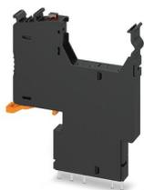
Adaptateur pour fiche de fusible à utiliser sur un bloc de jonction de base PLC de 6,2 mm. Pour fusibles 5 x 20 mm. Tension de service : 120 ... 230 V AC/DC. Avec LED pour l'affichage de la défaillance des fusibles.
