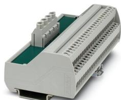
Module VARIOFACE, avec deux barres collectrices de potentiel (P1, P2) pour la répartition du potentiel, montage sur profilé NS 35. Pas du module : 131,5 mm
