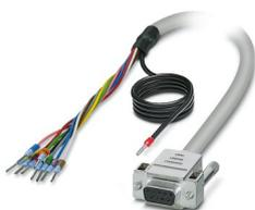
Câble rond blindé préconfectionné; raccordement 1 : Fils individuels (9-pôles) (Les fils sont repérés et équipés d'embouts. La tresse de blindage sort d'une extrémité de câble distincte.); raccordement 2 : Connecteur femelle D-SUB (1x 9-pôles); longueur de câble: 6 m
