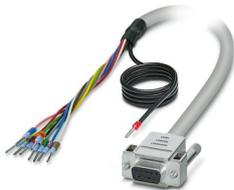
Câble rond blindé préconfectionné; raccordement 1 : Fils individuels (9-pôles) (Les fils sont repérés et équipés d'embouts. La tresse de blindage sort d'une extrémité de câble distincte.); raccordement 2 : Connecteur femelle D-SUB (1x 9-pôles); longueur de câble: 0,5 m
