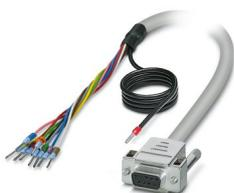
Câble rond blindé préconfectionné; raccordement 1 : Fils individuels (9-pôles) (Les fils sont repérés et équipés d'embouts. La tresse de blindage sort d'une extrémité de câble distincte.); raccordement 2 : Connecteur femelle D-SUB (1x 9-pôles); longueur de câble: 4 m
