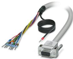
Câble rond blindé préconfectionné; raccordement 1 : Fils individuels (9-pôles) (Les fils sont repérés et équipés d'embouts. La tresse de blindage sort d'une extrémité de câble distincte.); raccordement 2 : Connecteur femelle D-SUB (1x 9-pôles); longueur de câble: 1,5 m
