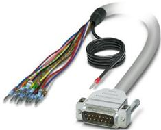
Câble rond blindé préconfectionné; raccordement 1 : Fils individuels (15-pôles) (Les fils sont repérés et équipés d'embouts. La tresse de blindage sort d'une extrémité de câble distincte.); raccordement 2 : Connecteur mâle D-SUB (1x 15-pôles); longueur de câble: 0,5 m
