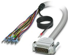
Câble rond blindé préconfectionné; raccordement 1 : Fils individuels (15-pôles) (Les fils sont repérés et équipés d'embouts. La tresse de blindage sort d'une extrémité de câble distincte.); raccordement 2 : Connecteur mâle D-SUB (1x 15-pôles); longueur de câble: 1,5 m
