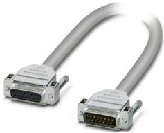
Câble rond prééquipé, blindé, exempt d'halogène; raccordement 1 : Connecteur femelle D-SUB (1x 15-pôles); raccordement 2 : Connecteur mâle D-SUB (1x 15-pôles); longueur de câble: 2 m
