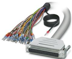
Câble rond blindé préconfectionné; raccordement 1 : Fils individuels (37-pôles) (Les fils sont repérés et équipés d'embouts. La tresse de blindage sort d'une extrémité de câble distincte.); raccordement 2 : Connecteur femelle D-SUB (1x 37-pôles); longueur de câble: 0,5 m
