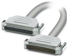
Câble rond prééquipé, blindé, exempt d'halogène; raccordement 1 : Connecteur femelle D-SUB (1x 37-pôles); raccordement 2 : Connecteur mâle D-SUB (1x 37-pôles); longueur de câble: 1 m
