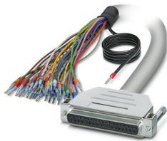
Câble rond blindé préconfectionné; raccordement 1 : Fils individuels (37-pôles) (Les fils sont repérés et équipés d'embouts. La tresse de blindage sort d'une extrémité de câble distincte.); raccordement 2 : Connecteur femelle D-SUB (1x 37-pôles); longueur de câble: 4 m
