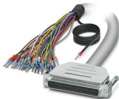
Câble rond blindé préconfectionné; raccordement 1 : Fils individuels (37-pôles) (Les fils sont repérés et équipés d'embouts. La tresse de blindage sort d'une extrémité de câble distincte.); raccordement 2 : Connecteur femelle D-SUB (1x 37-pôles); longueur de câble: 6 m
