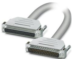
Câble rond blindé préconfectionné; raccordement 1 : Connecteur femelle D-SUB (1x 37-pôles); raccordement 2 : Connecteur mâle D-SUB (1x 37-pôles); longueur de câble: 1,5 m
