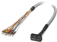
Câble rond pré-équipé; raccordement 1 : Fils individuels (16-pôles) (Les fils sont repérés et équipés d'embouts); raccordement 2 : IDC/FLK connecteur femelle (1x 16-pôles); longueur de câble: 0,5 m
