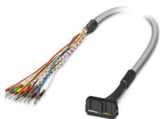
Câble rond pré-équipé; raccordement 1 : Fils individuels (16-pôles) (Les fils sont repérés et équipés d'embouts); raccordement 2 : IDC/FLK connecteur femelle (1x 16-pôles); longueur de câble: 4 m
