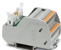
Module VARIOFACE, avec raccordements Push-in et connecteur pour câble en nappe, montage sur profilé NS 35, avec connecteur mâle et verrouillages à étrier court et long pour connecteurs femelles, nombre de pôles : 16
