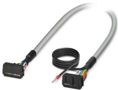
Câble rond blindé préconfectionné; raccordement 1 : IDC/FLK connecteur femelle (1x 14-pôles); raccordement 2 : IDC/FLK connecteur femelle (1x 14-pôles) (La tresse de blindage sort d'une extrémité de câble distincte.); longueur de câble: 1,2 m
