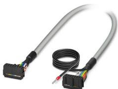
Câble rond blindé préconfectionné; raccordement 1 : IDC/FLK connecteur femelle (1x 14-pôles); raccordement 2 : IDC/FLK connecteur femelle (1x 14-pôles) (La tresse de blindage sort d'une extrémité de câble distincte.); longueur de câble: 1,8 m
