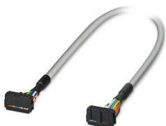
Câble rond prééquipé, exempt d'halogène; raccordement 1 : IDC/FLK connecteur femelle (1x 14-pôles); raccordement 2 : IDC/FLK connecteur femelle (1x 14-pôles); longueur de câble: 5 m
