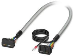
Câble rond blindé préconfectionné; raccordement 1 : IDC/FLK connecteur femelle (1x 14-pôles); raccordement 2 : IDC/FLK connecteur femelle (1x 14-pôles) (La tresse de blindage sort d'une extrémité de câble distincte.); longueur de câble: 10 m
