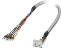
Câble rond pré-équipé; raccordement 1 : Fils individuels (10-pôles) (Les fils sont repérés et équipés d'embouts); raccordement 2 : IDC/FLK connecteur femelle (1x 10-pôles); longueur de câble: 2,5 m
