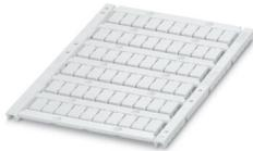
Repères pour blocs de jonction, Plaque, blanc, vierge, repérable avec : TOPMARK NEO, LASER TOPMARK, BLUEMARK ID COLOR, BLUEMARK ID, BLUEMARK CLED, THERMOMARK PRIME, THERMOMARK CARD 2.0, THERMOMARK CARD, type de montage: encliquetage, pour bloc de jonction au pas de : 6,2 mm, surface utile: 5,6 x 10,5 mm, Nombre d'étiquettes: 60
