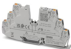
Protection électronique d'appareil mono-canal, pour récepteurs 12 - 24 V DC. Valeur fixe d'intensité nominale : 0,63 A. Avec signalisation à distance, réinitialisation à distance et limitation active du courant. Combinable en des blocs de jonction CLIPLINE. Pour l'installation sur des rails DIN.
