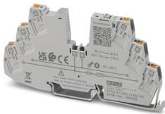
Protection électronique d'appareil mono-canal, pour récepteurs 12 - 24 V DC. Valeur fixe d'intensité nominale : 0,63 A. Avec signalisation à distance et limitation active du courant. Combinable en des blocs de jonction CLIPLINE. Pour l'installation sur des rails DIN.
