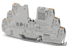
Protection électronique d'appareil mono-canal, pour récepteurs 12 - 24 V DC. Intensité nominale réglable de 0,1 à 0,63 A. Avec signalisation à distance et limitation active du courant. Combinable en des blocs de jonction CLIPLINE. Pour l'installation sur des rails DIN.
