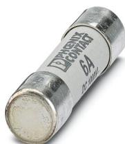
Fusible, pour l'industrie photovoltaïque selon UL 2579, tension nominale: 1000 V, intensité nominale: 6 A, hauteur: 38 mm, diamètre: 10,3 mm, coloris: blanc
