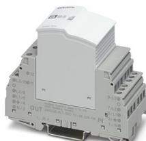
Protection d'appareil enfichable, suivant type 3 / Classe III, pour réseaux d'alimentation triphasés avec N et PE séparés (système à 5 fils : L1, L2, L3, N, PE), avec fusible résistant aux courants de choc intégré et avec contact de signalisation à distance.
