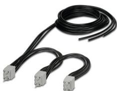
Pont à boucles triphasé pour 3 modules de la gamme CONTACTRON avec raccordement vissé et boîtier de 22,5 mm de large, longueur de câble entre les modules : 0,3 m, câble de raccordement : 2 m
