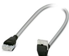
Câble rond pré-équipé; raccordement 1 : IDC/FLK connecteur femelle (1x 10-pôles, 180 °-sortie); raccordement 2 : IDC/FLK connecteur femelle (1x 10-pôles, 90 °-sortie); longueur de câble: 1,5 m
