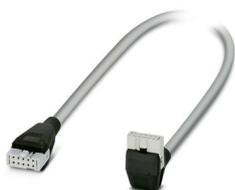
Câble rond pré-équipé; raccordement 1 : IDC/FLK connecteur femelle (1x 10-pôles, 180 °-sortie); raccordement 2 : IDC/FLK connecteur femelle (1x 10-pôles, 90 °-sortie); longueur de câble: 1 m
