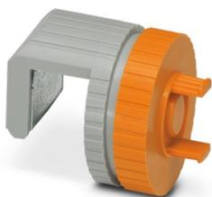
Le dispositif de maintien en option fournit une fixation en toute sécurité de la bobine de Rogowski sur des barres d'alimentation d'une épaisseur comprise entre 10 ... 15 mm. Lors de l'installation, le boîtier de la bobine coulisse sur la bride du dispositif de maintien et s'enclenche automatiquement.
