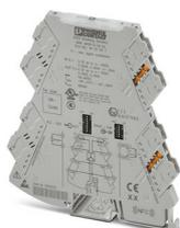
Amplificateur-séparateur à 3 voies avec technologie de raccordement enfichable et commutation calibrée de la plage de mesure pour l'isolation galvanique des signaux analogiques unipolaires ou bipolaires. Entrée et sortie configurables par DIP switch. Technologie de raccordement vissé, configuration standard.
