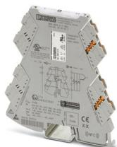
Commutateur de valeur-limite de température, à configuration universelle, avec sortie de relais NO pour le raccordement de thermomètres à résistance à 2, 3 ou 4 conducteurs et de thermocouples. Configurable avec un sélecteur de codage DIP ou un logiciel, raccordement vissé
