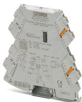
Convertisseur de fréquence analogique avec fonction de valeur seuil et connectique enfichable pour la conversion de signaux normalisés en signaux de fréquence ou PWM. Configurable avec un commutateur DIP ou un logiciel. Raccordement vissé, configuration à la commande.
