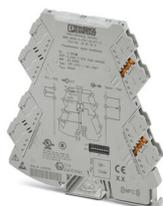
Convertisseur de mesure potentiomètre configurable avec technologie de raccordement enfichable pour le raccordement des potentiomètres de 0  $\Omega$  ... 100  $\Omega$  à 0 k $\Omega$  ... 100 k $\Omega$ . Configurable par DIP switch ou avec un logiciel. Technologie de raccordement Push-in, configuration à la commande
