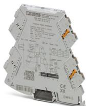
Convertisseur de fréquence à configuration universelle, pour la conversion des signaux de fréquence (Hz/rpm) et de modulation d'impulsions en largeur, en signaux normalisés. Tensions de capteur supérieure à 8,2 V DC, en relation avec MINI MCR-2-SPS-PT 1033201 possible. Technologie de raccordement Push-in.
