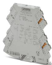
Séparateur d'alimentation à 3 voies avec technologie de raccordement enfichable. Transparent HART, signal d'entrée 0(4) mA ... 20 mA, signal de sortie 0(4) mA ... 20 mA. L'appareil peut être utilisé aussi bien en mode séparateur qu'en mode séparateur d'alimentation. Technologie de raccordement Push-in
