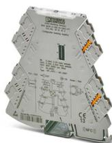
Amplificateur-séparateur à 4 voies à configuration universelle, avec sortie de couplage et technologie de raccordement enfichable pour l'isolation galvanique des signaux analogiques. Configurable par DIP switch ou avec un logiciel. Technologie de raccordement Push-in, configuration standard.
