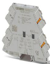
Amplificateur séparateur à 3 voies, avec entrée/sortie configurables, pour l'isolation galvanique et la conversion de signaux analogiques, dans la plage mV et V, aussi bien unipolaire que bipolaire. Connectique Push-in, configuration standard.
