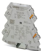
Doubleur d'alimentation 4 voies avec technologie de raccordement enfichable. Transparent HART, signal d'entrée 0(4) mA ... 20 mA, signaux de sortie 0(4) mA ... 20 mA. Il est possible d'utiliser l'appareil aussi bien en mode doubleur de signal qu'en mode doubleur d'alimentation. Technologie de raccordement vissé.
