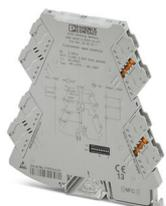
Convertisseur de mesure potentiomètre configurable avec technologie de raccordement enfichable pour le raccordement des potentiomètres de  $0 \Omega$  ...  $100 \Omega$  à  $0 \text{ k}\Omega$  ...  $100 \text{ k}\Omega$ . Configurable par DIP switch ou avec un logiciel. Technologie de raccordement Push-in, configuration standard
