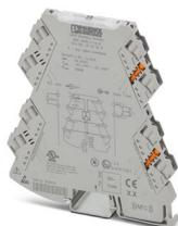
Amplificateur-séparateur à 3 voies avec technologie de raccordement enfichable pour l'isolation galvanique des signaux analogiques. Signal d'entrée : 0 V ... 10 V, signal de sortie : 4 mA ... 20 mA, technologie de raccordement vissé
