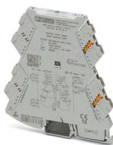
Doubleur d'alimentation 4 voies avec technologie de raccordement enfichable. Transparent HART, signal d'entrée 0(4) mA ... 20 mA, signaux de sortie 0(4) mA ... 20 mA. Il est possible d'utiliser l'appareil aussi bien en mode doubleur de signal qu'en mode doubleur d'alimentation. Technologie de raccordement Push-in.
