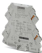
Convertisseur de température configurable avec technologie de raccordement enfichable pour le raccordement des sondes et des codeurs thermométriques à résistance à 2, 3 et 4 conducteurs. Configurable par DIP switch ou avec un logiciel. Technologie de raccordement vissé, configuration standard
