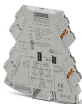
Amplificateur-séparateur à 3 voies avec technologie de raccordement enfichable et commutation calibrée de la plage de mesure pour l'isolation galvanique des signaux analogiques unipolaires ou bipolaires. Entrée et sortie configurables par DIP switch. Technologie de raccordement vissé, configuration à la commande.
