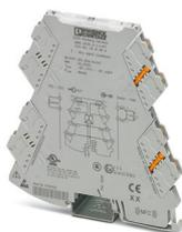
Amplificateur-séparateur à 3 voies avec connectique enfichable pour l'isolation galvanique de signaux analogiques. Signal d'entrée : 0(4) mA ... 20 mA, signal de sortie : 0(4) mA ... 20 mA, connectique Push-in.
