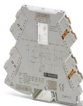
Commutateur de valeur-limite de température, à configuration universelle, avec sortie de relais NO pour le raccordement de thermomètres à résistance à 2, 3 ou 4 conducteurs et de thermocouples. Configurable via sélecteur de codage DIP ou logiciel. Connectique Push-in
