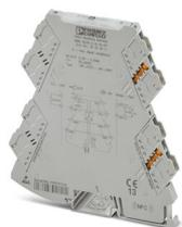
Amplificateur-séparateur à 3 voies avec connectique enfichable pour l'isolation galvanique de signaux analogiques. Signal d'entrée : 0 V ... 10 V, signal de sortie : 0 mA ... 20 mA, connectique Push-in
