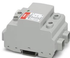
Parafoudre pour systèmes à tension continue PV à 2 pôles, isolés et mis à la terre, de 1 500 V DC, pour montage sur rail DIN, avec contact de télésignalisation, éléments de protection, avec contrôle de la température, affichage de l'état sur le module.
