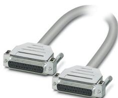
Câble rond prééquipé, blindé, exempt d'halogène; raccordement 1 : Connecteur femelle D-SUB (1x 25-pôles); raccordement 2 : Connecteur femelle D-SUB (1x 25-pôles); longueur de câble: 3 m
