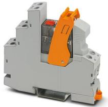
Module à relais prééquipé avec raccordement vissé, comprenant : embase de relais, étrier de fixation du relais, module antiparasite enfichable et relais à contacts de puissance avec touche de contrôle et LED de statut intégrée. Type de contact : 2 contacts inverseurs. Tension d'entrée : 230 V AC
