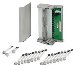
Termination Carrier universel pour la connexion de 16 amplificateurs-séparateurs MACX Analog Ex i à des cartes E/S TOR ou analogiques, via connecteurs D-SUB, 37 pôles (liaison 1:1)
