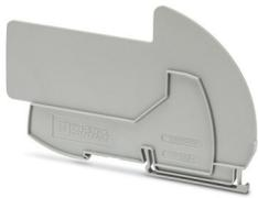
Séparateur VIP I/O-Marshalling pour la séparation sûre entre des modules embase équipés non Ex i et Ex i, dans des systèmes Honeywell. Le séparateur est montée directement sur le rail DIN, à l'extrémité du module embase.
