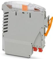
Module porte-fusible pour éléments de base VIP I/O, avec fusibles de 1 A remplaçables dans le circuit d'alimentation des appareillages de terrain et dans le circuit de signalisation. Des points de test intégrés et un couteau de sectionnement permettent la mesure sans interruption des signaux.
