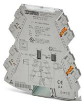
Amplificateur-séparateur à 3 voies, avec entrée/sortie configurables, pour l'isolation galvanique et la conversion de signaux analogiques, dans les plages mV et V, aussi bien unipolaire que bipolaire. Raccordement vissé, configuration à la commande.
