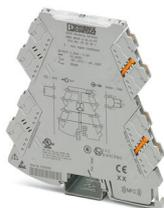
Amplificateur-séparateur à 3 voies avec technologie de raccordement enfichable pour l'isolation galvanique des signaux analogiques. Signal d'entrée : 0 mA ... 20 mA, signal de sortie : 0 V ... 10 V, technologie de raccordement Push-in
