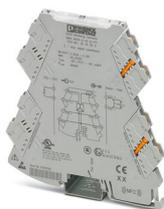
Amplificateur-séparateur à 3 voies avec technologie de raccordement enfichable pour l'isolation galvanique des signaux analogiques. Signal d'entrée : 4 mA ... 20 mA, signal de sortie : 0 V ... 10 V, technologie de raccordement Push-in
