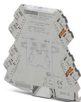
Séparateur 2 voies à 1 canal alimenté par la boucle de sortie avec technologie de raccordement enfichable, pour l'isolation galvanique de signaux analogiques. Signal d'entrée = signal de sortie : 0(4) mA ... 20 mA. Avec raccordement vissé.
