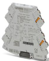
Convertisseur de fréquence à configuration universelle, pour la conversion des signaux de fréquence (Hz/rpm) et de modulation d'impulsions en largeur, en signaux normalisés. Tensions de capteur supérieure à 8,2 V DC, en relation avec MINI MCR-2-SPS-PT 1033201 possible. Technologie de raccordement Push-in, configuration à la commande.
