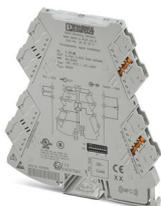
Convertisseur de mesure potentiomètre configurable avec technologie de raccordement enfichable pour le raccordement des potentiomètres de  $0 \Omega$  ...  $100 \Omega$  à  $0 \text{ k}\Omega$  ...  $100 \text{ k}\Omega$ . Configurable par DIP switch ou avec un logiciel. Technologie de raccordement vissé, configuration à la commande
