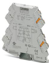
Amplificateur-séparateur à 3 voies avec connectique enfichable pour l'isolation galvanique de signaux analogiques unipolaires et bipolaires. Signal d'entrée : 0 .. 10 V (+/-)10 V, signal de sortie : 0 ..10 V (+/-)10 V, connectique Push-in.
