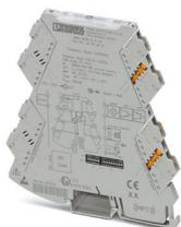
Convertisseur de fréquence à configuration universelle, pour la conversion des signaux de fréquence (Hz/rpm) et de modulation d'impulsions en largeur, en signaux normalisés. Tensions de capteur supérieure à 8,2 V DC, en relation avec MINI MCR-2-SPS 1033202 possible. Raccordement vissé.
