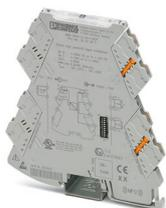
Séparateur 2 voies alimenté par boucle de sortie avec connectique enfichable, pour l'isolation galvanique de signaux analogiques unipolaires et bipolaires. Entrée configurable par commutateur DIP. Raccordement vissé, configuration à la commande.
