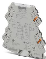
Amplificateur-séparateur à 3 voies avec technologie de raccordement enfichable pour l'isolation galvanique des signaux analogiques. Signal d'entrée : 0 mA ... 20 mA, signal de sortie : 0 V ... 10 V, technologie de raccordement vissé
