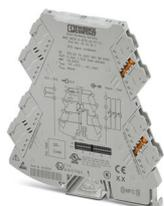
Convertisseur de température configurable avec technologie de raccordement enfichable pour le raccordement des sondes et des codeurs thermométriques à résistance à 2, 3 et 4 conducteurs. Configurable par DIP switch ou avec un logiciel. Technologie de raccordement Push-in, configuration à la commande
