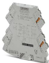
Convertisseur de température configurable avec technologie de raccordement enfichable pour le raccordement des sondes et des codeurs thermométriques à résistance à 2, 3 et 4 conducteurs. Configurable par DIP switch ou avec un logiciel. Technologie de raccordement Push-in, configuration standard
