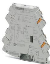
Séparateur 2 voies alimenté par la boucle de sortie avec technologie de raccordement enfichable pour l'isolation galvanique des signaux analogiques unipolaires ou bipolaires. Entrée configurable par DIP switch. Technologie de raccordement vissé, configuration standard.
