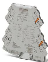
Séparateur d'alimentation à 3 voies avec technologie de raccordement enfichable. Transparent HART, signal d'entrée 0(4) mA ... 20 mA, signal de sortie 0(4) mA ... 20 mA. L'appareil peut être utilisé aussi bien en mode séparateur qu'en mode séparateur d'alimentation. Technologie de raccordement vissé
