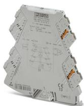
Amplificateur-séparateur à 3 voies avec connectique enfichable pour l'isolation galvanique de signaux analogiques. Signal d'entrée : 0 V ... 10 V, signal de sortie : 0 mA ... 20 mA, connectique Push-in
