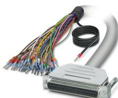
Câble rond blindé préconfectionné; raccordement 1 : Fils individuels (37-pôles) (Les fils sont repérés et équipés d'embouts. La tresse de blindage sort d'une extrémité de câble distincte.); raccordement 2 : Connecteur femelle D-SUB (1x 37-pôles); longueur de câble: 1 m
