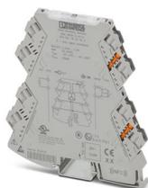
Amplificateur-séparateur à 3 voies avec technologie de raccordement enfichable pour l'isolation galvanique des signaux analogiques. Signal d'entrée : 4 mA ... 20 mA, signal de sortie : 0 V ... 10 V, technologie de raccordement vissé
