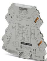
Convertisseur de température configurable avec technologie de raccordement enfichable pour le raccordement des sondes et des codeurs thermométriques à résistance à 2, 3 et 4 conducteurs. Configurable par DIP switch ou avec un logiciel. Technologie de raccordement vissé, configuration à la commande
