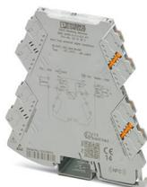
Séparateur 2 voies à 1 canal alimenté par la boucle d'entrée avec technologie de raccordement enfichable, pour l'isolation galvanique de signaux analogiques. Signal d'entrée = signal de sortie : 0(4) mA ... 20 mA. Technologie de raccordement Push-in.
