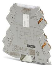
Commutateur de valeur-limite de température, à configuration universelle, avec sortie de relais NO pour le raccordement de thermomètres à résistance à 2, 3 ou 4 conducteurs et de thermocouples. Configurable via sélecteurs de codage DIP ou logiciel. Connectique Push-in
