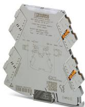
Séparateur 2 voies à 1 canal alimenté par la boucle de sortie avec technologie de raccordement enfichable, pour l'isolation galvanique de signaux analogiques. Signal d'entrée = signal de sortie : 0(4) mA ... 20 mA. Technologie de raccordement Push-in.
