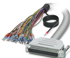
Câble rond blindé préconfectionné; raccordement 1 : Fils individuels (37-pôles) (Les fils sont repérés et équipés d'embouts. La tresse de blindage sort d'une extrémité de câble distincte.); raccordement 2 : Connecteur femelle D-SUB (1x 37-pôles); longueur de câble: 15 m
