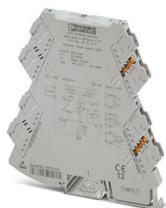
Séparateur d'alimentation à 3 voies avec technologie de raccordement enfichable. Transparent HART, signal d'entrée 0(4) mA ... 20 mA, signal de sortie 0(4) mA ... 20 mA. L'appareil peut être utilisé aussi bien en mode séparateur qu'en mode séparateur d'alimentation. Technologie de raccordement Push-in
