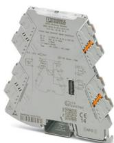
Séparateur 2 voies alimenté par la boucle de sortie avec technologie de raccordement enfichable pour l'isolation galvanique des signaux analogiques unipolaires ou bipolaires. Entrée configurable par DIP switch. Technologie de raccordement Push-in, configuration standard.
