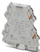
Amplificateur-séparateur à 3 voies avec connectique enfichable pour l'isolation galvanique de signaux analogiques. Signal d'entrée 0(4) mA ... 20 mA, signal de sortie : 0(4) mA ... 20 mA, raccordement vissé
