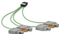
Jeu de câbles destiné à la transmission des signaux sur le Termination Carrier pour modules de la série MINI Analog Pro. Raccordement des points de connexion 5 et 6 de deux modules MINI Analog Pro voisins au circuit imprimé de signalisation via un connecteur PTSM à 4 pôles.
