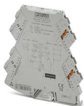
Convertisseur de mesure potentiomètre configurable avec technologie de raccordement enfichable pour le raccordement des potentiomètres de 0 Ω ... 100 Ω à 0 kΩ ... 100 kΩ. Configurable par DIP switch ou avec un logiciel. Technologie de raccordement Push-in, configuration standard
