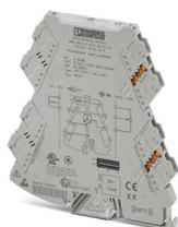
Convertisseur de mesure potentiomètre configurable avec technologie de raccordement enfichable pour le raccordement des potentiomètres de  $0 \Omega$  ...  $100 \Omega$  à  $0 \text{ k}\Omega$  ...  $100 \text{ k}\Omega$ . Configurable par DIP switch ou avec un logiciel. Technologie de raccordement Push-in, configuration à la commande
