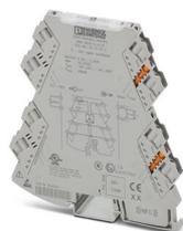
Amplificateur-séparateur à 3 voies avec technologie de raccordement enfichable pour l'isolation galvanique des signaux analogiques. Signal d'entrée : 0 V ... 10 V, signal de sortie : 0 mA ... 20 mA, technologie de raccordement vissé
