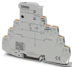
Parafoudre basse tension, avec indicateur d'état intégré et commutateur rotatif pour un circuit de signalisation bifilaire indépendant du potentiel de terre, p. ex. boucle de courant 0(4)...20 mA, homologation EX e pour zone 2, compatible HART.
