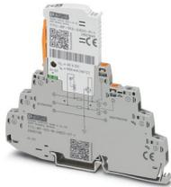
Parafoudre basse tension comprenant une fiche de protection et un élément de base à indicateur d'état intégré et à couteau de sectionnement, pour un circuit de signalisation bifilaire sans potentiel de terre, par ex. une boucle de courant 0(4) ... 20 mA, homologation EX e pour zone 2, compatible HART.
