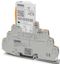
Parafoudre basse tension comprenant une fiche de protection et un élément de base à indicateur d'état intégré et à couteau de sectionnement, pour un circuit de signalisation bifilaire sans potentiel de terre, par ex. une boucle de courant 0(4) ... 20 mA, homologation EX e pour zone 2, compatible HART.
