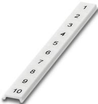
Ruban de repérage ZB, plat, Rubans, blanc, repéré, impression transversale: numérotation continue 1 ... 10, 11 ... 20, etc. jusqu'à 91 ... 100, type de montage: encliquetage, pour bloc de jonction au pas de : 6,2 mm, surface utile: 5,15 x 6,15 mm, Nombre d'étiquettes: 10
