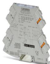
Commutateur de valeur-limite de température, à configuration universelle, avec deux sorties transistor pour le raccordement de thermomètres à résistance à 2, 3 ou 4 conducteurs et de thermocouples. Configurable avec un sélecteur de codage DIP ou un logiciel, connectique Push-in
