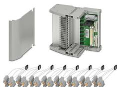
Termination Carrier universel pour la connexion de 16 amplificateurs-séparateurs MINI Analog Pro à des cartes E/S TOR ou analogiques, via connecteurs D-SUB, 37 pôles (liaison 1:1), avec raccordement de multiplexeur HART
