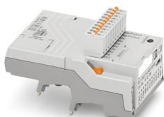
Module de base PLC logic avec raccordement RS-485 pour communication Modbus/RTU, avec 16 E/S, enfichable sur 8 blocs de jonction TOR ou analogiques PLC-INTERFACE, extension possible à 48 E/S, horloge en temps réel, connecteur femelle micro USB, logement pour module de mémoire et adaptateur Bluetooth, raccordement Push-in
