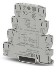
Convertisseur de température Pt 100/Pt 1000 pour modules logiques PLC logic (2e génération uniquement), à 1 canal, type de signal (Pt 100, Pt 1000) configurable via DIP switch, raccordement vissé
