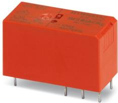
Relais de puissance miniature enfichable, étanchéité RT III avec contacts de puissance, 2 contacts inverseurs, tension d'entrée : 12 V DC, en association avec embase PLC correspondante homologuée selon ATEX/CEIEx (Zone 2) et Ex-Zone Class I, Div. 2.
