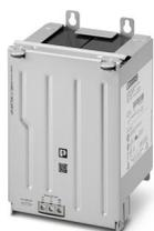
Stockage d'énergie, Lithium-Ion ( $\text{LiFePO}_4$ ), 24 V DC, 128 Wh. Pour une utilisation avec une QUINT-UPS, avec des températures ambiantes (charge) de 0 °C ... 60 °C et courant de charge maximum de 5 A. Veuillez tenir compte du V/C Level admis de l'alimentation sans interruption si la charge a lieu à une température inférieure à 0 °C.
