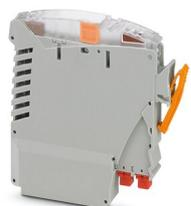
Module porte-fusible pour éléments de base VIP I/O, avec fusibles de 0,5 A remplaçables dans le circuit d'alimentation des appareillages de terrain et dans le circuit de signalisation. Des points de test intégrés et un couteau de sectionnement permettent la mesure sans interruption des signaux.
