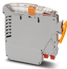
Module porte-fusible pour éléments de base VIP I/O-Marshalling, avec fusible de 2 A remplaçable dans le circuit d'alimentation des appareillages de terrain. Des points de test intégrés et un couteau de sectionnement permettent la mesure des signaux sans interruption.
