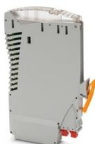
Amplificateur-séparateur d'entrée et d'alimentation à sécurité intrinsèque, HART pour éléments de base VIP I/O-Marshalling : transmet des signaux de 0/4 ... 20 mA provenant d'une zone ATEX (zone 2, CID2) à une charge (active ou passive) dans la zone protégée. Isolation galvanique à 3 voies
