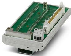
Module d'interface VARIOFACE pour Siemens SIMATIC® S5-95U, avec un connecteur pour câble en nappe de 50 pôles pouvant être couplé sur l'automate S7, largeur de module : 135 mm
