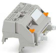
Adaptateur V8 pour 8 x PLC-INTERFACE (6,2 mm), automate: Câblage système API des cartes de sortie, raccordement 1: IDC/FLK connecteur mâle 1x 14-pôles, raccordement 2: Raccord enfichable (Encliquetable sur les 8x blocs de jonction PLC-INTERFACE), raccordement 3: Raccordement vissé 1x 2-pôles, nombre de canaux: 8, logique de commande: plusschaltend
