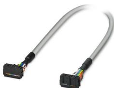
Câble rond prééquipé, exempt d'halogène; raccordement 1 : IDC/FLK connecteur femelle (1x 14-pôles); raccordement 2 : IDC/FLK connecteur femelle (1x 14-pôles); longueur de câble: 1 m
