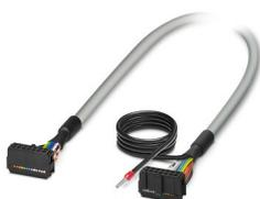
Câble rond blindé préconfectionné; raccordement 1 : IDC/FLK connecteur femelle (1x 14-pôles); raccordement 2 : IDC/FLK connecteur femelle (1x 14-pôles) (La tresse de blindage sort d'une extrémité de câble distincte.); longueur de câble: 0,5 m
