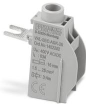
Bloc de jonction de dérivation, utilisable uniquement en combinaison avec la série VAL-Safe Energy Control-T2, Tension nominale : 400 V, Intensité nominale : 63 A, Type de raccordement : raccordement vissé, Section nominale : 25 mm<sup>2</sup>, Section : 1,5 mm<sup>2</sup> - 25 mm<sup>2</sup>, Coloris : gris
