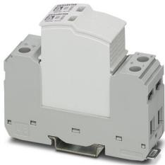
Parasurtenseur enfichable, selon type 2 / classe II, pour des sources de courant CC avec caractéristique de fonctionnement linéaire, avec contact de signalisation à distance.
