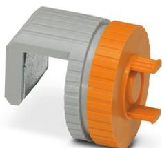
Le dispositif de maintien en option fournit une fixation en toute sécurité de la bobine de Rogowski sur des barres d'alimentation d'une épaisseur comprise entre 5 et 10 mm. Lors de l'installation, le boîtier de la bobine coulisse sur la bride du dispositif de maintien et s'enclenche automatiquement.
