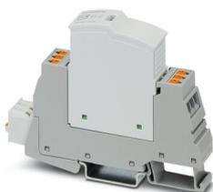
Parafoudre basse tension de type 2/3 composé d'une fiche de protection et d'un élément de base pour indicateur d'état intégré et signalisation à distance pour les réseaux d'alimentation monophasés. Tension nominale : 120 V AC/DC
