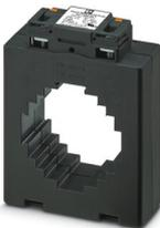
Transformateur de courant enfichable à raccordement vissé ou Push-in, raccordement du conducteur directement par le haut avec Push-in, aucun outil nécessaire. Sélections possibles : courant primaire (200 ... 1600) A AC, courant alternatif (1 ou 5) A AC, classe de précision 0,5 ou 1, puissance VA
