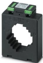
Transformateur de courant enfichable, courant primaire réglable de 200 ... 1 250 A AC ; courant secondaire réglable de 1 A AC ou de 5 A AC ; classe de précision réglable de 0,5 ou 1 ; puissance de référence réglable
