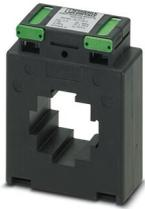
Transformateur de courant enfichable, courant primaire réglable entre 75 et 1 000 A AC ; courant secondaire réglable de 1 A AC ou 5 A AC ; classe de précision réglable de 0,5 ou 1 ; puissance de référence réglable
