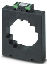
Transformateur de courant enfichable, courant primaire réglable entre 800 et 4 000 A AC; courant secondaire réglable sur 1 A AC ou 5 A AC ; classe de précision réglable sur 0,5 ou 1 ; puissance de référence réglable
