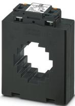
Transformateur de courant enfichable à raccordement vissé ou Push-in, raccordement du conducteur directement par le haut avec Push-in, aucun outil nécessaire. Sélections possibles : courant primaire (100 ... 1 500) A AC, courant alternatif (1 ou 5) A AC, classe de précision 0,5 ou 1, puissance VA
