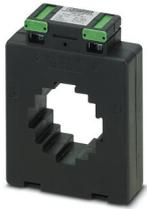
Transformateur de courant enfichable, courant primaire réglable entre 100 et 2 500 A AC ; courant secondaire réglable de 1 A AC ou 5 A AC ; classe de précision réglable de 0,5 ou 1 ; puissance de référence réglable
