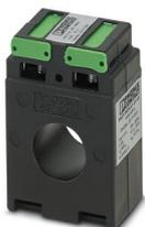
Transformateur de courant à canon, courant primaire réglable entre 50 et 500 A AC ; courant secondaire réglable de 1 A AC ou 5 A AC ; classe de précision réglable de 0,5 ou 1 ; puissance de référence réglable
