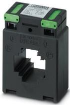
Transformateur de courant enfichable, courant primaire réglable entre 50 et 750 A AC ; courant secondaire réglable de 1 A AC ou 5 A AC ; classe de précision réglable de 0,5 ou 1 ; puissance de référence réglable
