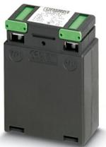
Transformateur de courant à bobinage, courant primaire réglable de 1 à 40 A AC ; courant secondaire réglable de 1 A AC ou 5 A AC ; classe de précision réglable de 0,5 ou 1 ; puissance de référence réglable
