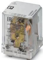
Relais haute puissance enfichable avec contacts de puissance, conçu spécialement pour la commutation de charges DC élevées, 1 contact à fermeture, aimant soufflant, tension de bobine : 110 V DC
