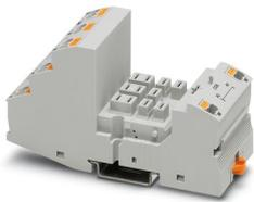
Embase de relais RIF-4..., pour relais de puissance avec 2 ou 3 contacts inverseurs ou 3 contacts NO, raccordement Push-in, enfichabilité pour modules d'entrée/antiparasite, montage sur NS 35/7,5
