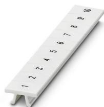
Ruban de repérage ZB, Rubans, blanc, repéré, repérable avec : CMS-P1-PLOTTER, impression longitudinale: numérotation continue 1 ... 10, 11 ... 20, etc. jusqu'à 491 ... 500, type de montage: encliquetage, pour bloc de jonction au pas de : 6,2 mm, surface utile: 6,15 x 10,5 mm, Nombre d'étiquettes: 10
