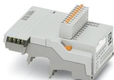
Module d'extension PLC logic à 16 E/S, pour le raccordement enfichable sur huit blocs de jonction PLC-INTERFACE destiné à l'extension du module de base (deux modules d'extension au maximum peuvent être raccordés à un module de base), raccordement Push-in
