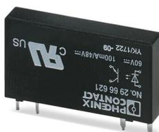
Relais à semi-conducteurs miniature enfichable, relais d'entrée à semi-conducteurs, 1 contact NO, entrée : 60 V DC, sortie : 3-48 V DC/100 mA
