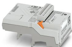
Module de base PLC logic, 2e génération, avec 16 E/S, enfichable sur huit blocs de jonction PLC-INTERFACE TOR ou analogiques, extension possible à 48 E/S, horloge en temps réel, connecteur femelle micro USB, logement pour module de mémoire et adaptateur Bluetooth, raccordement vissé
