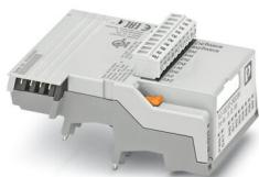
Module d'extension PLC logic à 16 E/S, pour le raccordement enfichable sur huit blocs de jonction PLC-INTERFACE destiné à l'extension du module de base (deux modules d'extension au maximum peuvent être raccordés à un module de base), raccordement vissé
