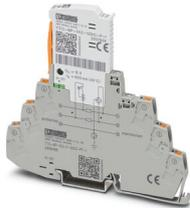
Protection antisurtension, consistant en une fiche de protection antisurtension et un élément de base, avec indicateur d'état intégré et sectionnement par couteau pour un circuit de signal bifilaire sans potentiel de terre. Mise à la terre indirecte via éclateur à gaz.
