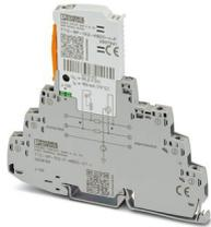
Protection antisurtension, consistant en une fiche de protection antisurtension et un élément de base, avec indicateur d'état intégré et sectionnement par couteau pour un circuit de signal bifilaire sans potentiel de terre. Mise à la terre indirecte via éclateur à gaz.
