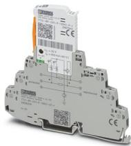
Protection antisurtension, consistant en une fiche de protection antisurtension et un élément de base, avec indicateur d'état intégré pour deux fils de signaux à potentiel de référence commun, par ex. Entrée/Sortie numérique. Mise à la terre indirecte via éclateur à gaz.
